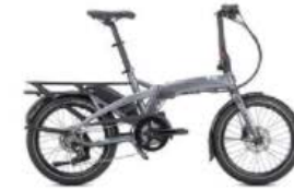
Faltrad mit elektrischer Unterstützung: Tern Vektron PT1
